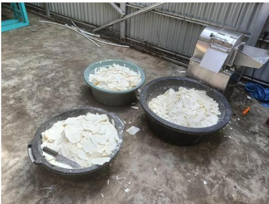
Gambar 8. Pemotongan Singkong dengan Mesin Pemotong
