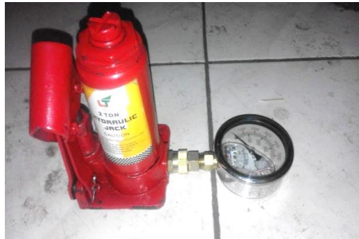
Gambar 16. Dongkrak dengan pressure gauge
