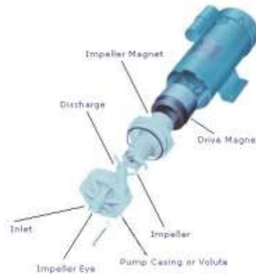
Gambar 4. Pompa sentrifugal dan bagian-bagiannya Sumber: www.lytron.com
