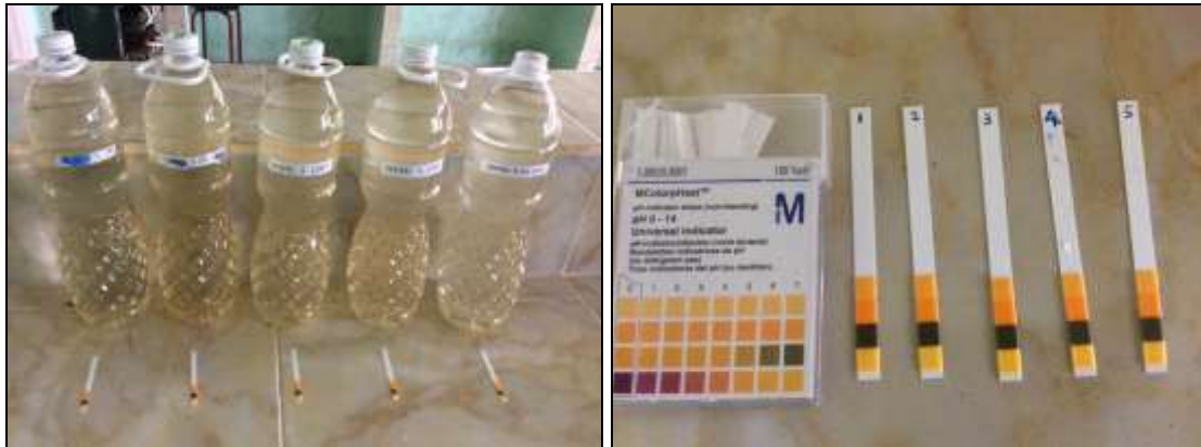
Gambar 1. Pengujian pH dari sampel air tanah UMSB
