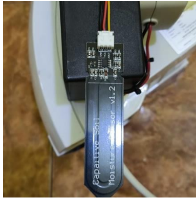
Gambar 6. Pemasangan Sensor Kelembaban (Sumber: Dokumen Pribadi, 2024)
