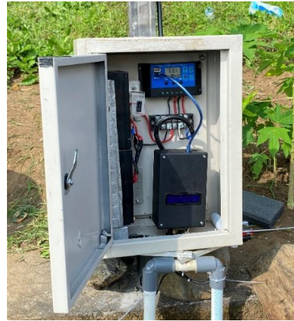
Gambar 13. Hasil Perancangan dan Pemasangan Sistem Monitoring
