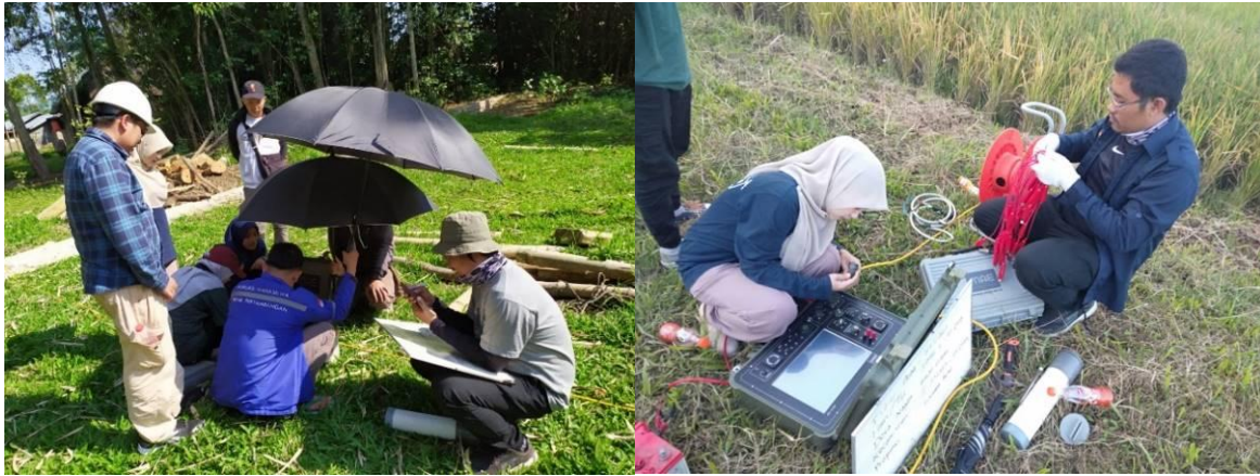
Gambar 11. Pelaksanaan Pengukuran Geolistrik (GL1 dan GL2)
