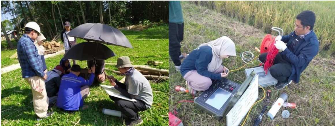
Gambar 11. Pelaksanaan Pengukuran Geolistrik (GL1 dan GL2)
