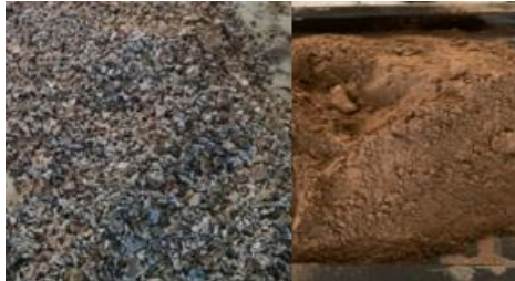
Gambar 2. Biji Plastik dan Fly Ash sebagai Bahan Penyusun Batako
