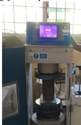
Gambar 8. Pengujian Kuat Tekan
