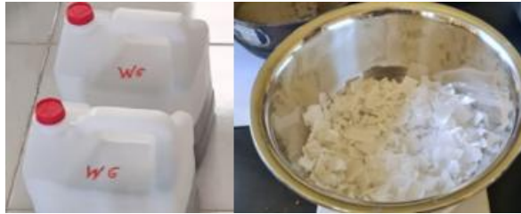
Gambar 1. Sodium Silikat dan Sodium Hidrosida Bahan Pengikat Material Batako
