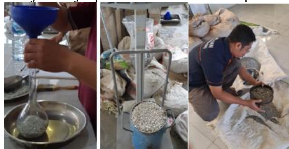
Gambar 3. Pengujian Berat isi, Berat jenis dan Gradasi Biji Plastik
