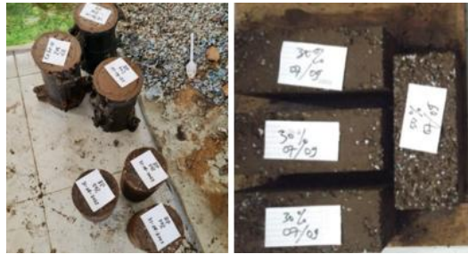
Gambar 6. Pembuatan Benda Uji Silinder dan Benda Batako Green Material
