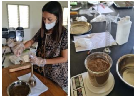
Gambar 5. Pengujian Berat isi, Berat jenis Fly Ash
