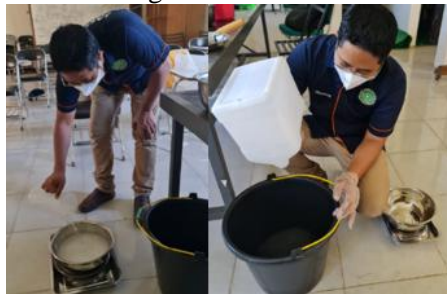
Gambar 3. Pembuatan Mix Aktivator dari Sodium Hidrosida dan Sodium Silikat
