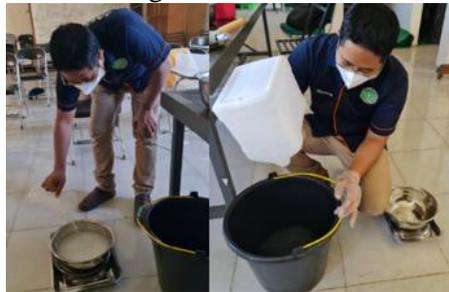
Gambar 3. Pembuatan Mix Aktivator dari Sodium Hidrosida dan Sodium Silikat
