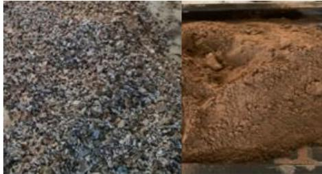
Gambar 2. Biji Plastik dan *Fly Ash* sebagai Bahan Penyusun Batako**B. Mix aktivator (Air, Sodium Hidrosida dan Sodium Silikat)**
