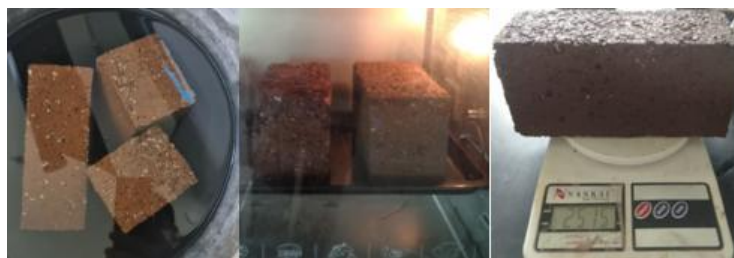
Gambar 7. Pengujian Serapan Air dan Berat Isi Batako
