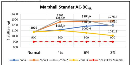
Nilai stabilitas marshall standar campuran aspal beton AC-BC $_{NR}$  ditinjau dari variasi kealusan abu sekam padi cenderung mengalami peningkatan. Pada campuran AC-BC $_{NR}$  normal nilai stabilitas marshall standar adalah sebesar 1076 kg, nilai stabilitas marshall standar variasi kehalusan abu sekam
