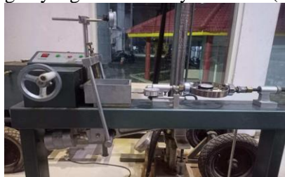
Gambar 7. Uji kuat geser langsung (data hasil penelitian)
