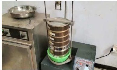
Gambar 4. Uji gradasi ayakan (data hasil penelitian)
