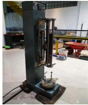
Gambar 5. Uji pemadatan standar proctor test (data hasil penelitian)
