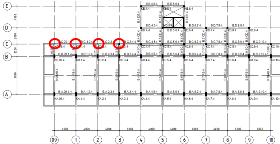
Gambar 1. Lokasi kolom yang tidak ditemukan pada tipikal denah gedung lantai 1 s.d 4.
