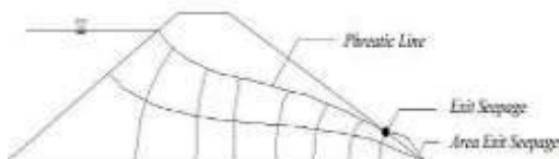
Gambar 3. Exit seepage pada tubuh bendungan (U.S Army Corps of Engineering, 1993)
