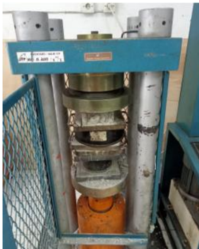
Gambar 5. Pengujian Kuat Tekan Benda Uji Paving Block
