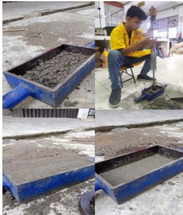
Gambar 3. Pembuatan Benda Uji Paving Block
