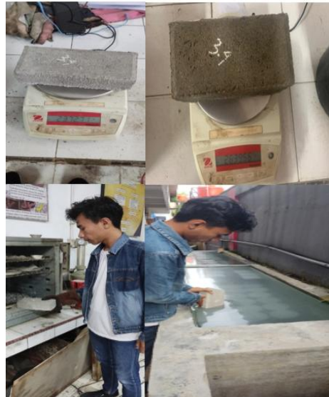
Gambar 6. Pengujian Penyerapan Air Benda Uji Paving Block
