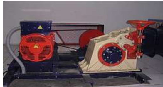
Gambar 7. PLTMH Tipe Cross Flow (Sumber: Rompas, 2011)
