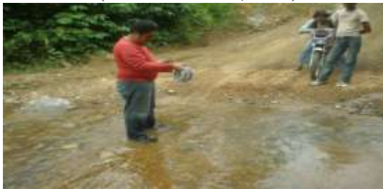
Gambar 6. Pengukuran Kecepatan Aliran Air (Sumber: Subekti, 2010)
