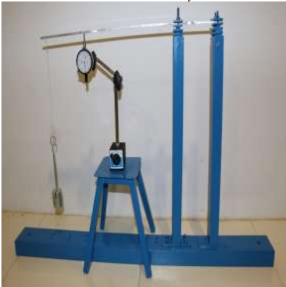
Gambar 3 Gambar alat uji defleksi horizontal dengan tumpuan kantilever
