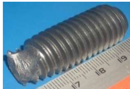
Gambar 5. Profil patahan baut yang gagal.
